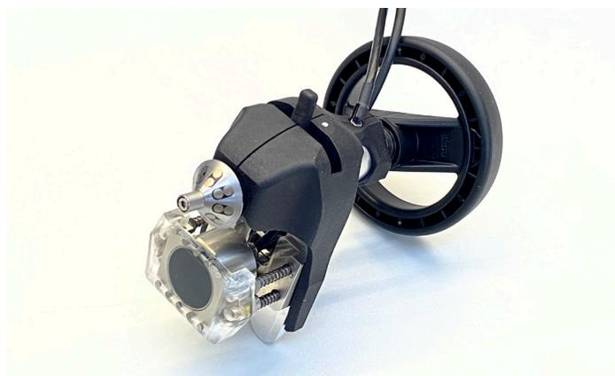
única sonda de matriz en fase (phased array, o PA). Esta solución flexible permite lograr los ángulos de conducción requeridos para cubrir de manera óptima toda la superficie lateral del eje. De esta manera, se logra una inspección más fiable dado a que la única sonda PA del SAMT genera un riesgo menor de pérdida del acoplamiento UT.
