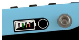
Εικόνα 2: Ένδειξη κατάστασης μπαταρίας
